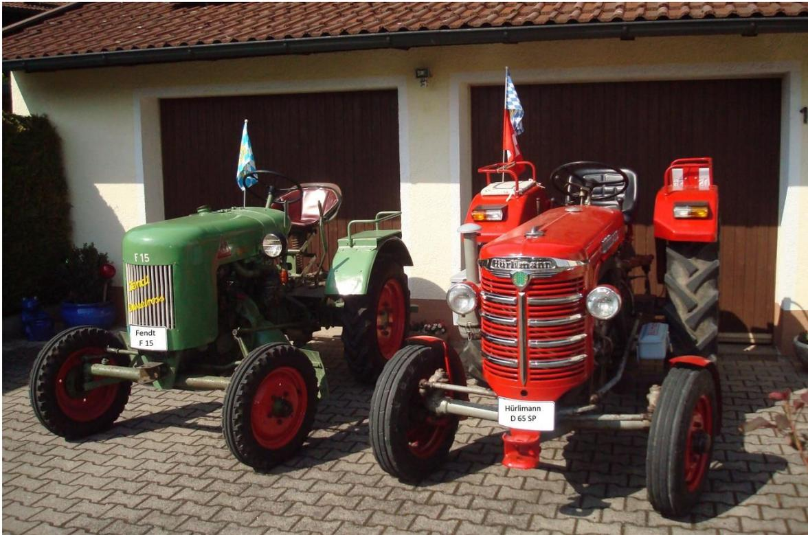
Hürlimann D65SP Import aus der Schweiz, Baujahr 1966, Leistung 45 PS, 4 Zylinder Reihenmotor (Diesel), Zustand nicht restauriert
